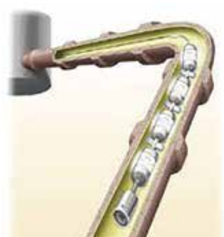
FRP光硬化取付管ライニング工法
